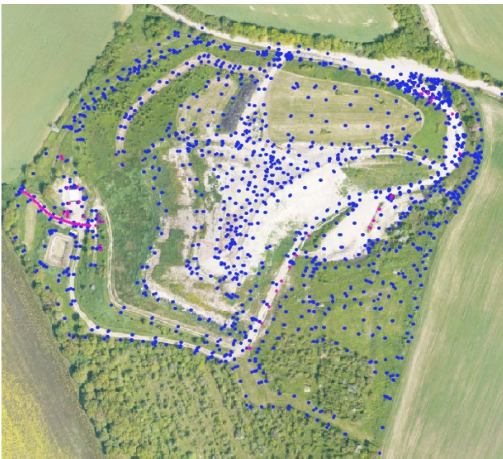
Obrázek 10. Geodetické zaměření skládky (modré body), a body zaměřené polní GPS (Topcon HiPer HR) pro účely zpracování technologie (růžové body) na skládce Klobouky u Brna. Pozadí je RGB ortofoto pořízené 28. 5. 2023 (FLIS).
