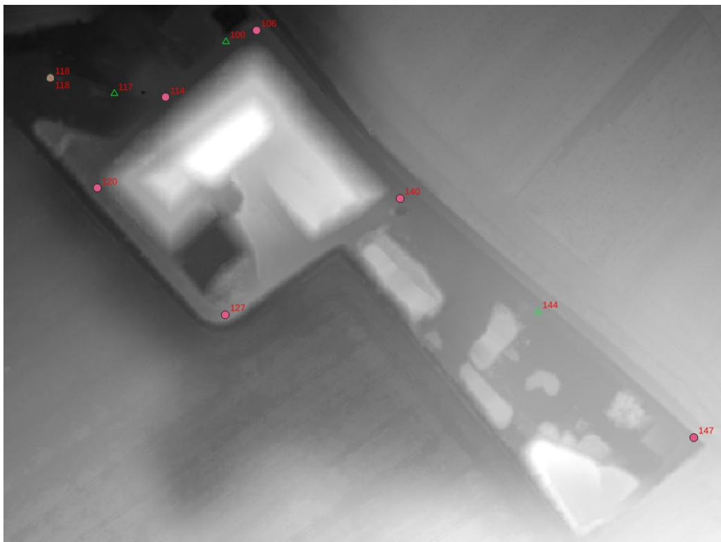
Obrázek 2. Pozice GPS měření použité pro stanovení poziční chyby. Kroužkem jsou označeny body pro chybu Z, trojúhelníkem body použité pro stanovení chyby XY.
